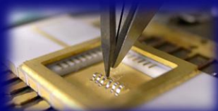
マイクロセンサをセッティングをするワイヤーボンダー
