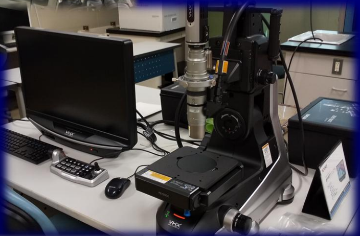
マイクロセンサ等の形状を正確に解析できるデジタルマイクロスコープ
