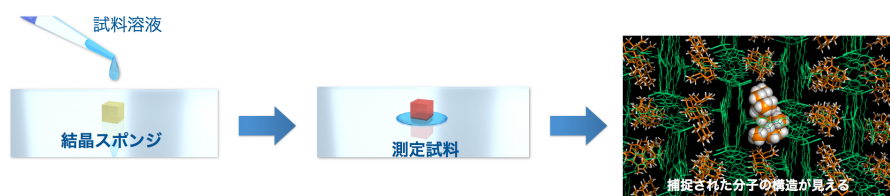
図1. CS法の概念図：細孔性錯体（結晶スポンジ）にサンプルを吸収させX線測定を行うと、結晶スポンジ内に捕捉されたゲストの構造が観測される。
